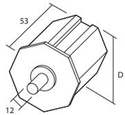
Cápsula de plástico con espiga metálica de  $\varnothing$  12 mm.
