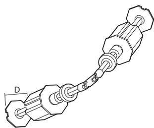
Cápsula doble regulable con nudo para ángulos y rodamiento de Ø 42 mm. Ángulo máximo 30°.
