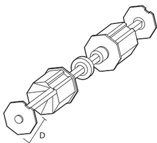
Cápsula doble regulable de 300 mm. con rodamiento de Ø 42 mm.
